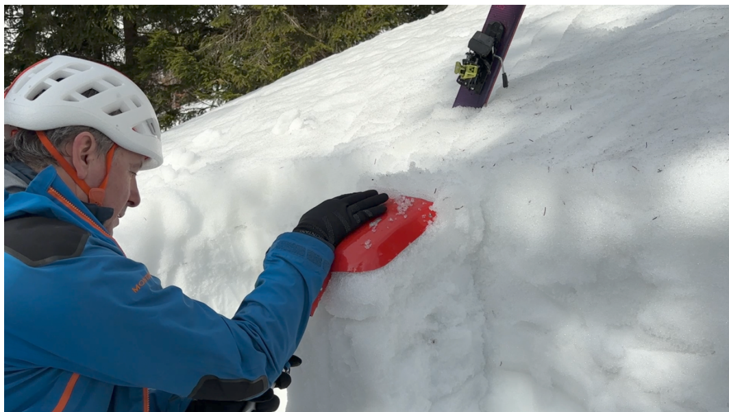
Obrázek č. 33: Provedení kompresního testu
