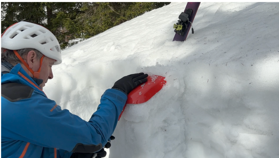
Obrázek č. 33: Provedení kompresního testu
