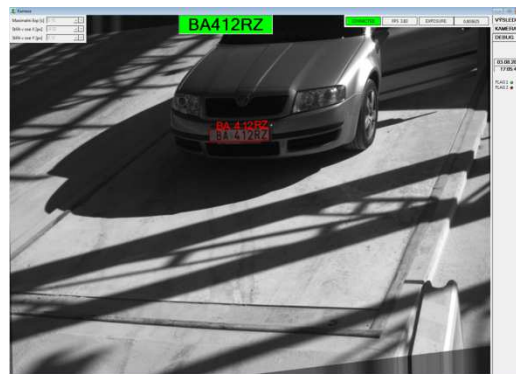
Obr.20 Korekce zešikmení obrazu při nerovnoměrném okolním osvětlení[17]
