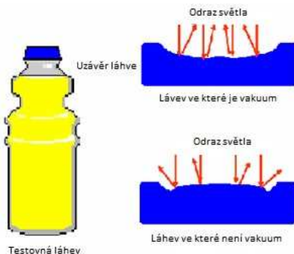
Obr.19 Zjišťování přítomnosti vakua v láhvi[25]
