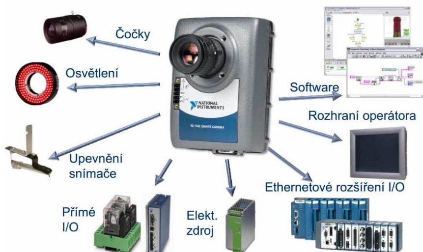
Obr. 11 Ekosystém smart kamer od společnosti National Instruments Zdroj: http://web.spsc.v.cz/~kaderabek/oscilokopy/kis.pdf
