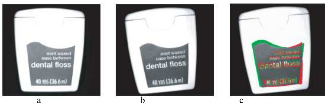
Obr.17 Lícování se zlatým vzorem. a)Zlatý vzor b)Snímáný objekt c) Výsledek po inspekci [5]
