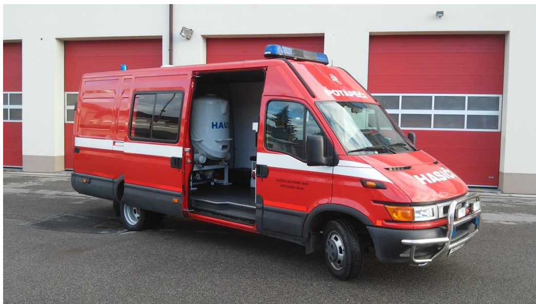
Obrázek 4 Speciální vozidlo IVECO Dailly 50 C 13V, které slouží k přepravě mobilní dvoumístné dekompresní komory HAUX-MEDICOM 5,5
