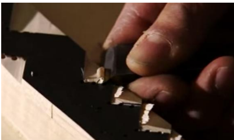
Obr. 30- Štechování kobylek firmy Fazioli
