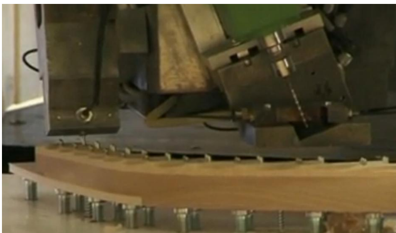
Obr. 36- Naražení kobylykových hřebů za pomoci CNC
