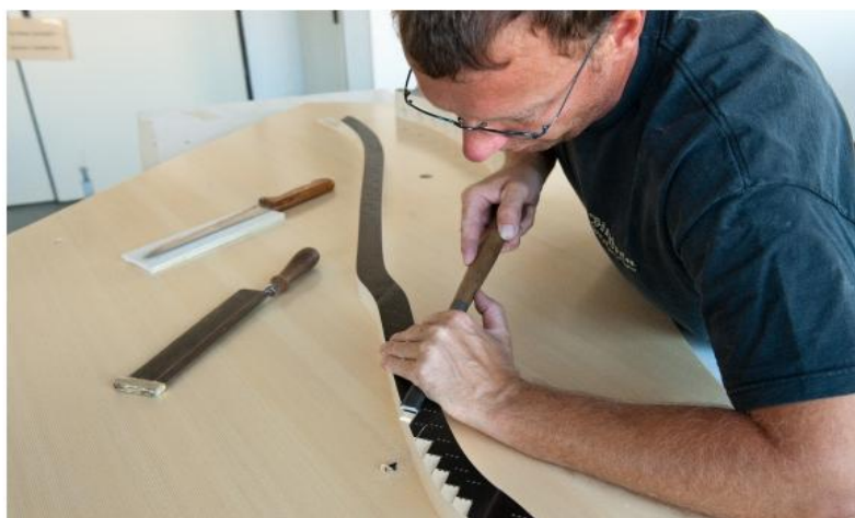
Obr. 28- Štechování kobyly firmy Bösendorfer
