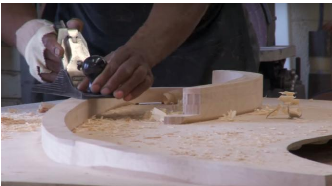
Obr. 32- Hoblování strunového přetlaku
