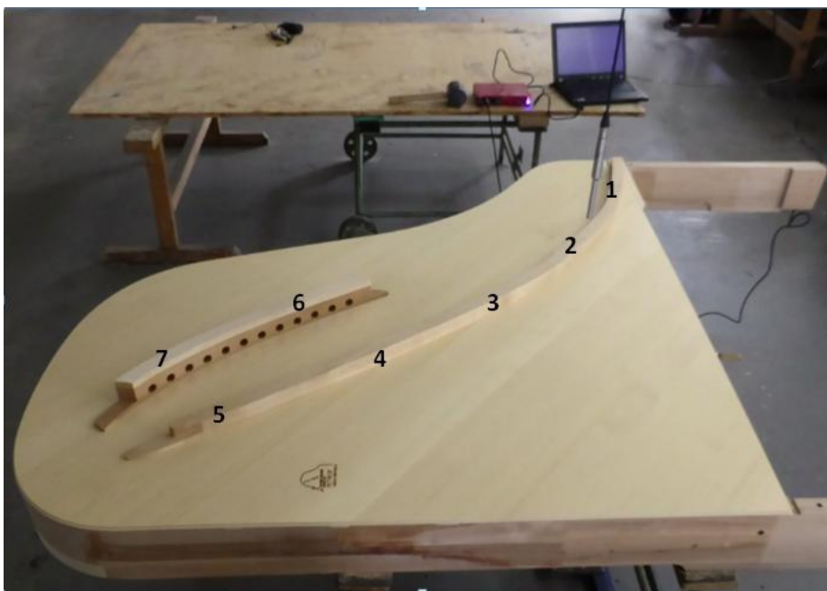
Obr. 42 - Měření vlastních frekvencí ozvučnicku nástroje
