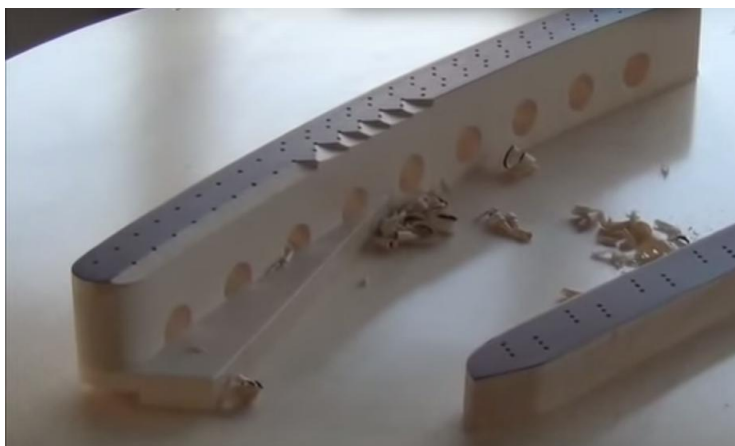
Obr. 27- Odlehčení basové kobyly firmy Bösendorfer
