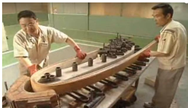
Obr. 37- Ohýbání a lepení lamelové kobyly
