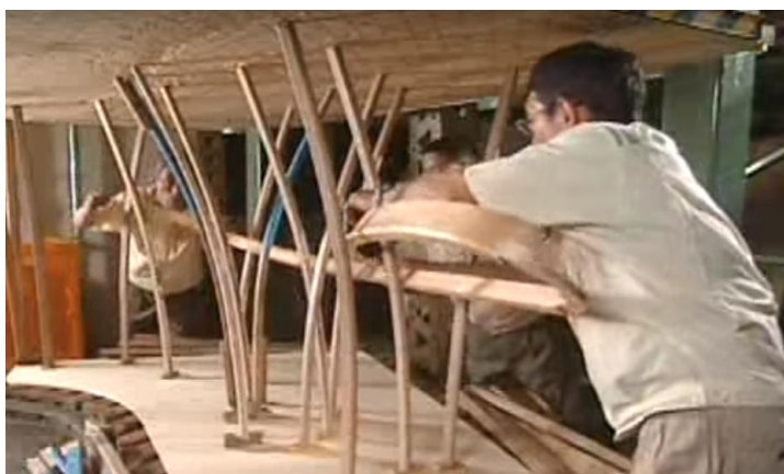
Obr. 38- Lepení kobyly koncertního nástroje řady CFX
