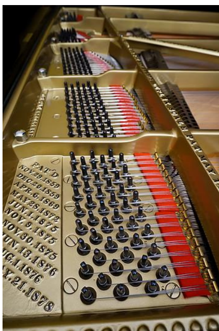
Obr. 22- Litinový rám modelu Centennial
