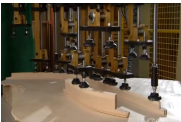
Obr. 20- Lepení kobylek pomocí hydraulického lisu
