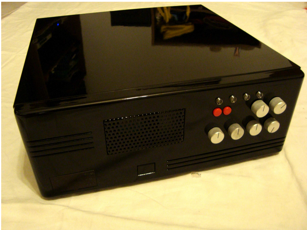
Obr. 10.6 Pohled na čelní panel výkonového zesilovače
