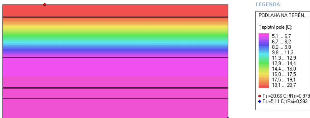
Obr. 18 Rozložení teplot v konstrukci podlahy.
