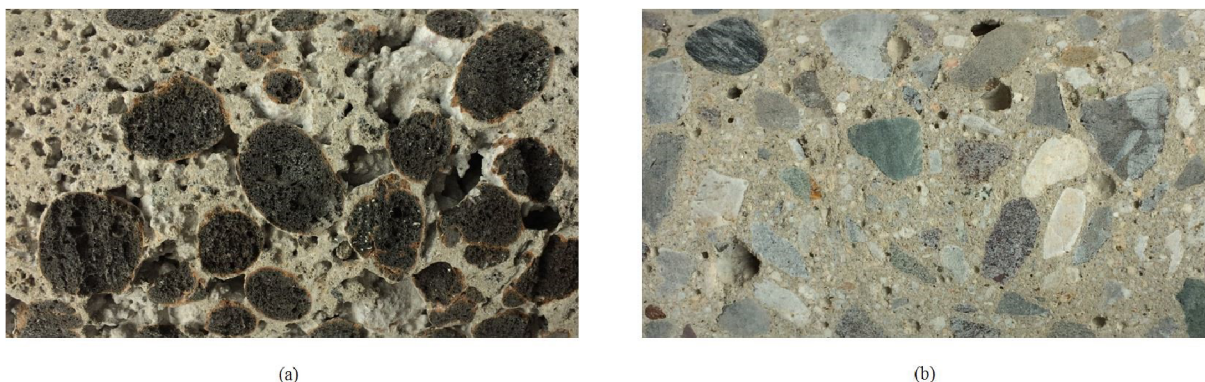
Obr. 26 Průřezy vzorků matečního betonu: (a) RCA-01 – průčelní lehký stěnový panel fasády; (b) RCA-02 – Nosný panel vnitřní stěny
