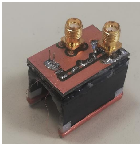
Obr. 48: Sestavená experimentální část budicího bloku senzoru průtokoměru
