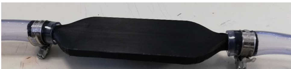
Obr. 60: Měřicí vedení, její napojení na přívod a regulaci rychlosti proudění kapaliny.
