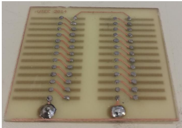
Obr. 51: Snímací deska navrženého průtokoměru
