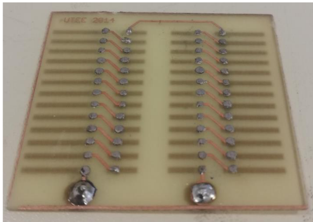
Obr. 51: Snímací deska navrženého průtokoměru
