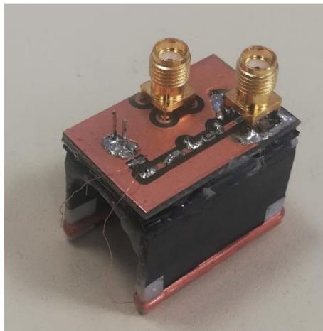
Obr. 48: Sestavená experimentální část budicího bloku senzoru průtokoměru
