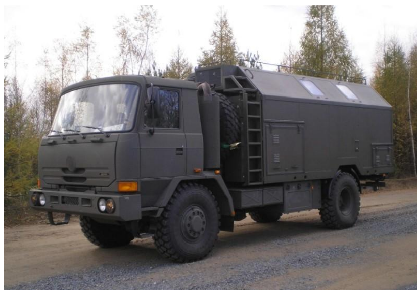
Obrázek 8: Automobilní skříňová dílna pro opravy kolové techniky ASkD – K na podvozku Tatra - 815
