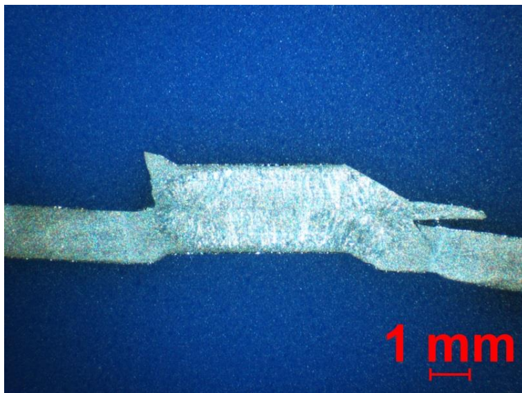
Obr. 29 - Makrostruktura svaru číslo 14
