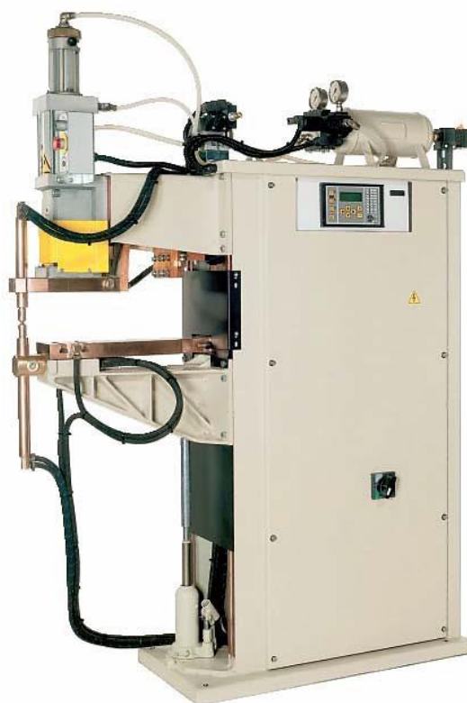
Obr. 18 - Invertorový odporový svařovací lis TECNA - typ 6124 [16]
