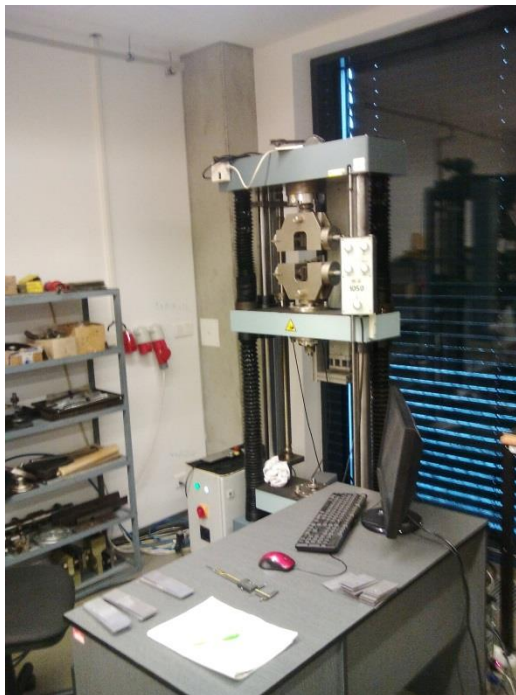
Obr. 22 - Trhací zařízení TIRA test 2300
