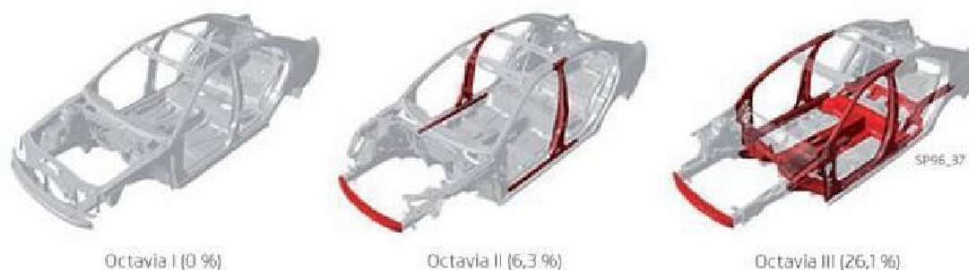
Obr. 1 – Podíly manganbórových ocelových plechů s povlakem na bázi Al-Si na modelech Octavia I, II a III [14]
