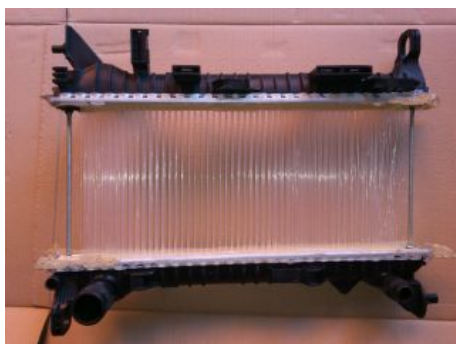
(a) Výměník 7 - neopláštěný
