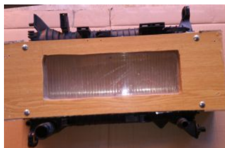
(b) Výměník 7 - opláštěný
