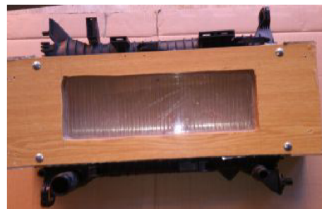
(b) Výměník 7 - opláštěný
