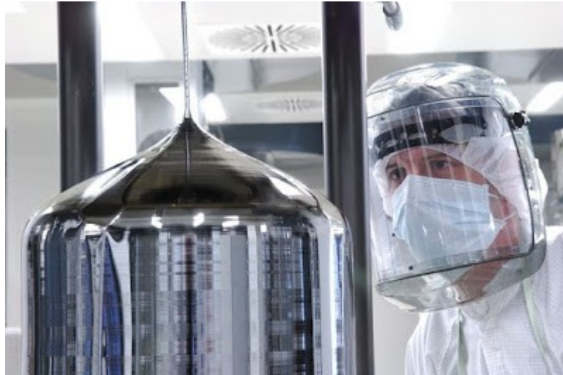
Obr. 11: Monokrystal křemíku vyráběný pro polovodičovou elektroniku ( https://www.frm2.tum.de/fileadmin/_processed_/csm_SiltronicSiliciumeinkristall_ba41669f4d.jpg )
