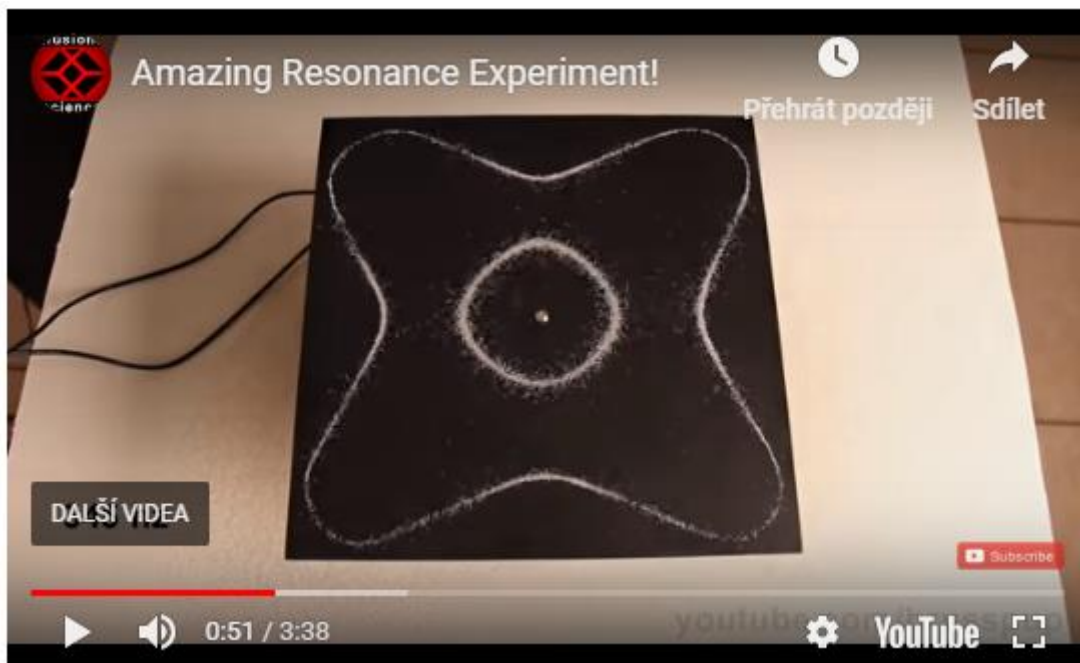
Obrázek 14: Experiment s chladniho deskou, v závislosti na frekvencích, PrtSc videa, celé na: https://edu.techmania.cz/cs/katalog/edutorium-i/378/chladniho-obrazce
