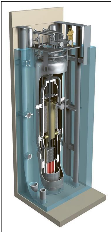
Obrázek 11 - Řez tlakového reaktoru Nuscale. [28]
