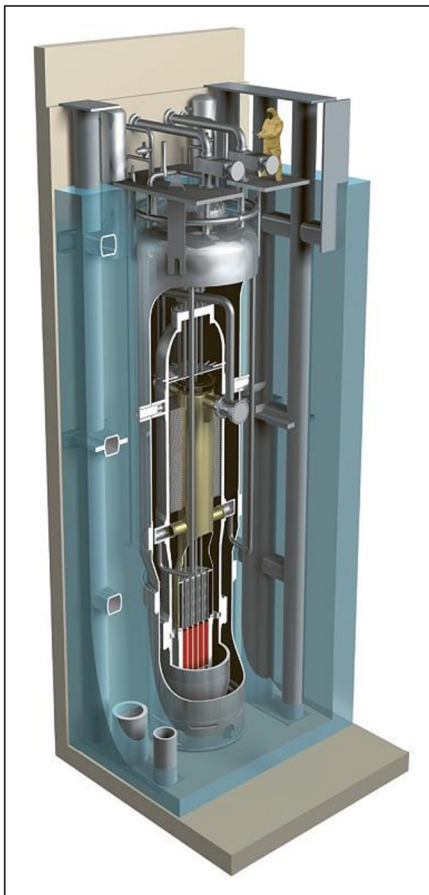
Obrázek 11 - Řez tlakového reaktoru Nuscale. [28]
