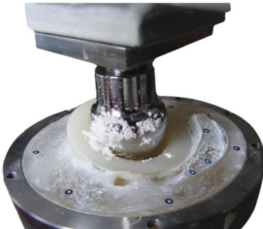
Obrázek 16: Kyvadlový simulátor otěru PE jamky (Ranuša 2016).
