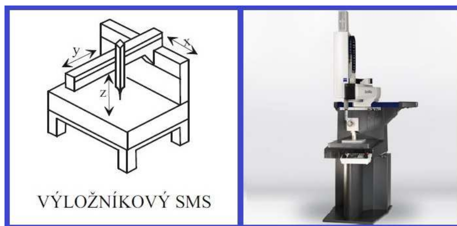
Obrázek 5.3 – Schéma a příklad výložníkového SMS
