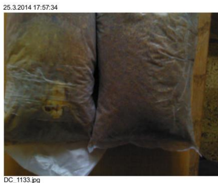
Foto č. 9: Snímek rukávu naočkovaného Trichoderma pleurotum a kontrolního vzorku ve viditelném spektru záření - stejné vzorky jako na fotografii č. 8 (pořadí vzorků zleva)
