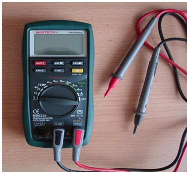
Obr. 11 Digitální multimetr s automatickým přepínáním rozsahů [6]
