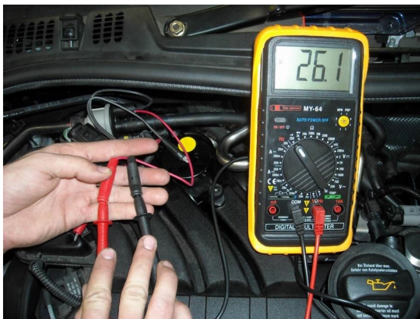
Obr. 27 Měření odporu vinutí regeneračního ventilu [vlastní]
