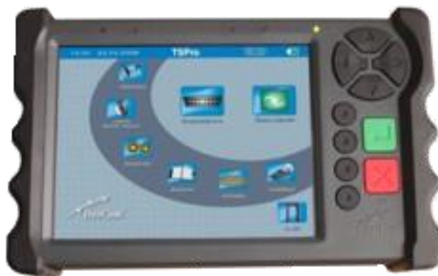
Obr. 5 Diagnostický přístroj Devcom TS pro Color [5]
