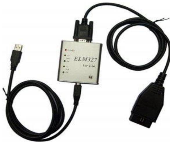
Obr. 10 Diagnostický přístroj k PC ELM 327 [5]
