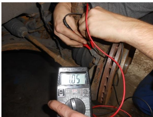
Obr. 42 Měření senzoru ABS multimetrem [vlastní]
