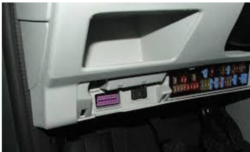
Obr. 2 Příklad umístění OBD-II zásuvky [3]
