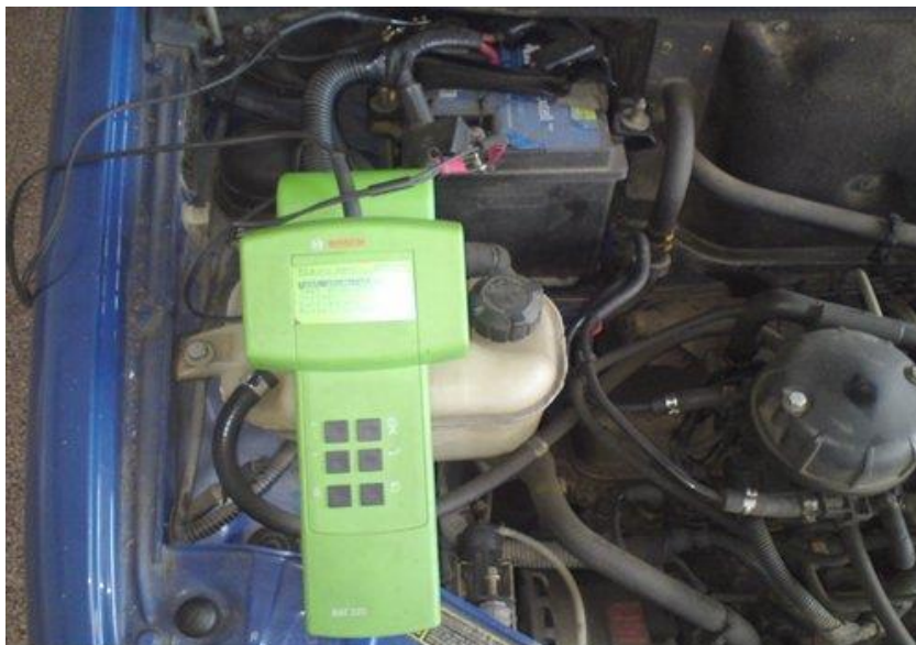
Obr. 12 Připojení testeru k vozidlu [7]
