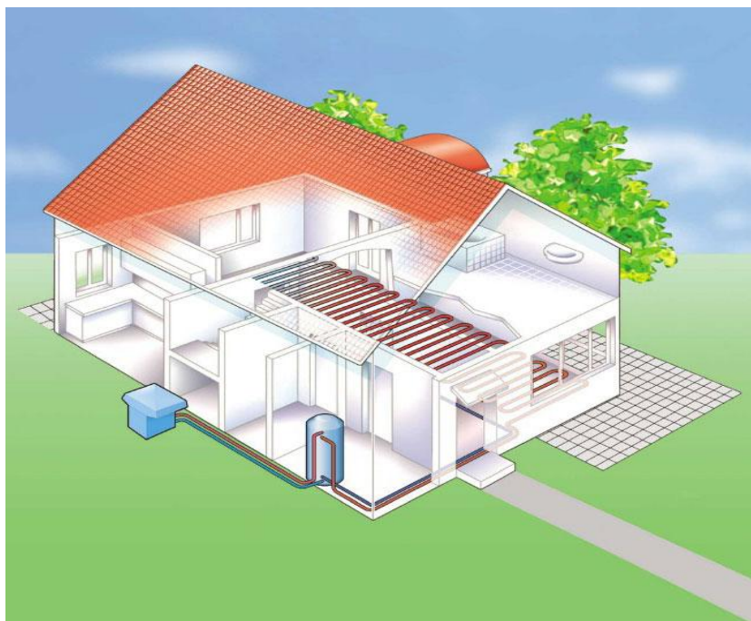
Obrázek 8: Princip tepelného čerpadla vzduch/voda – venkovní provedení [27]
