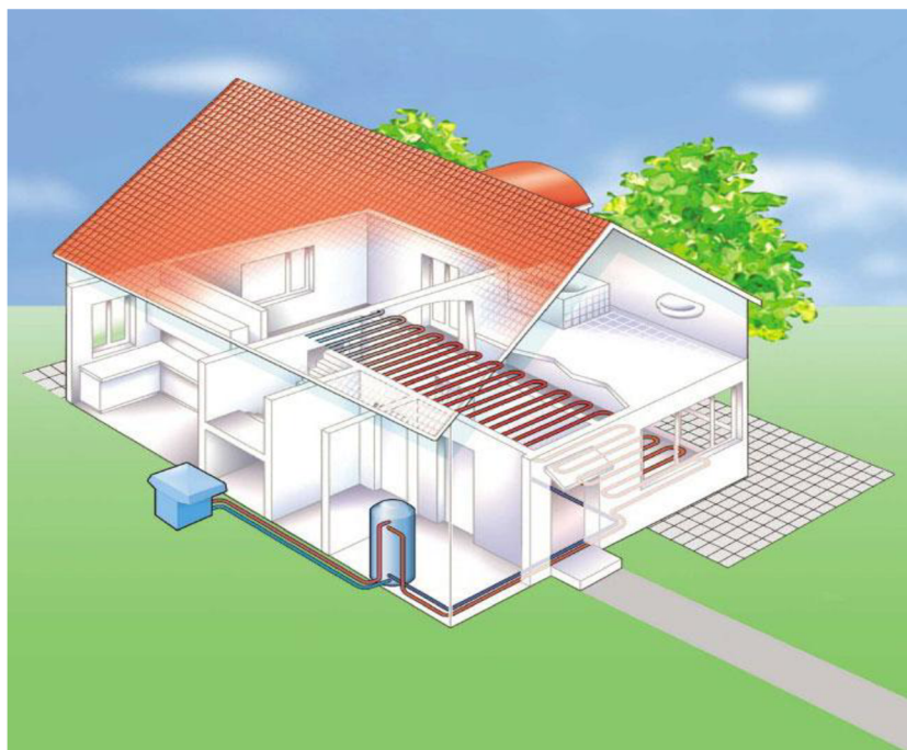
Obrázek 8: Princip tepelného čerpadla vzduch/voda – venkovní provedení [27]
