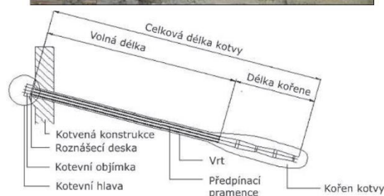
Obr. č. 79 Provádění kotev [21]
