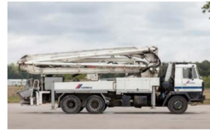
Obr. č. 44 Autočerpadlo [24]
