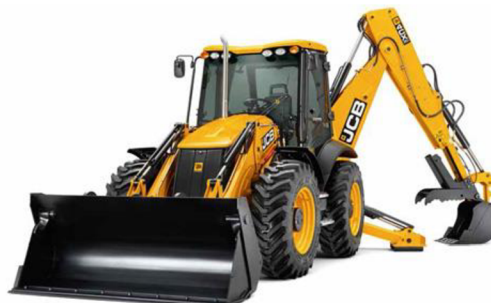
Obr. č. 33 Rýpadlo – nakladač [14]
