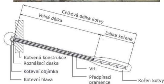
Obr. č. 79 Provádění kotev [21]
