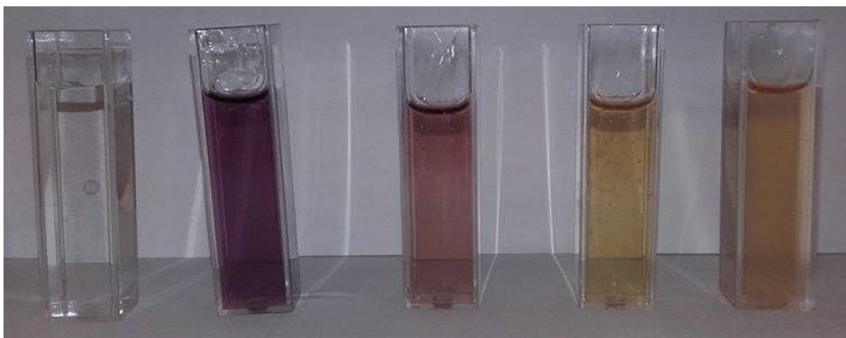
Obr. č. 28 Stanovení antioxidační kapacity u vzorku černého rybízu Ben Lomond v čase 3 minuty. Zleva: destilovaná voda, roztok DPPH s destilovanou vodou v poměru 1:1, mražený vzorek, sušený vzorek a lyofilizovaný vzorek
