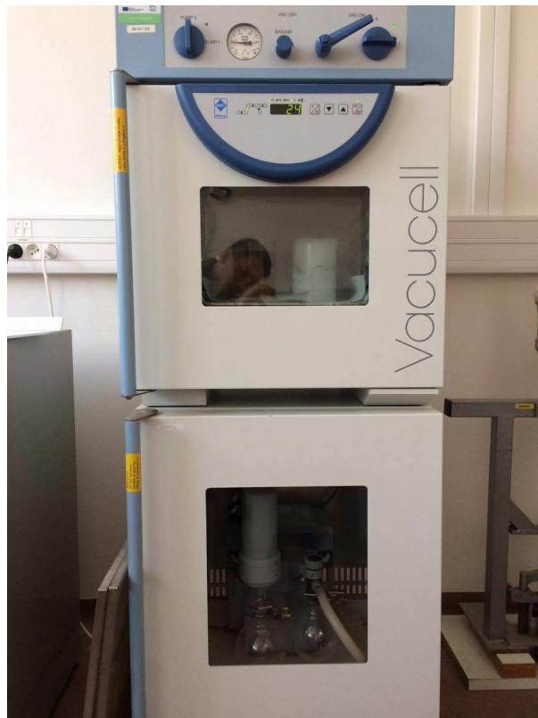
Obr. 8 Vakuová sušárna značky VacuCell použitá pro podtlakovou impregnaci dřeva
