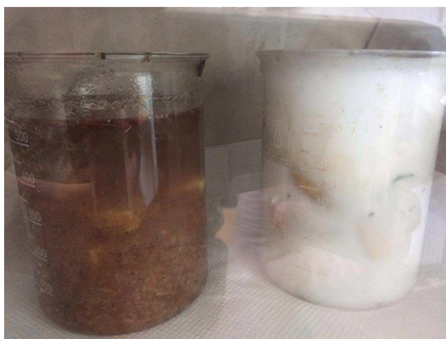
Obr. 6 Vzorky ponořené ve smolnaté a syntetické pryskyřici připravené na vakuovou impregnaci
