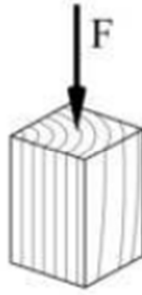
Obr. 15 Působení tlaku podél vláken zkušebního tělesa o rozměrech 20 \times 20 \times 30 mm
