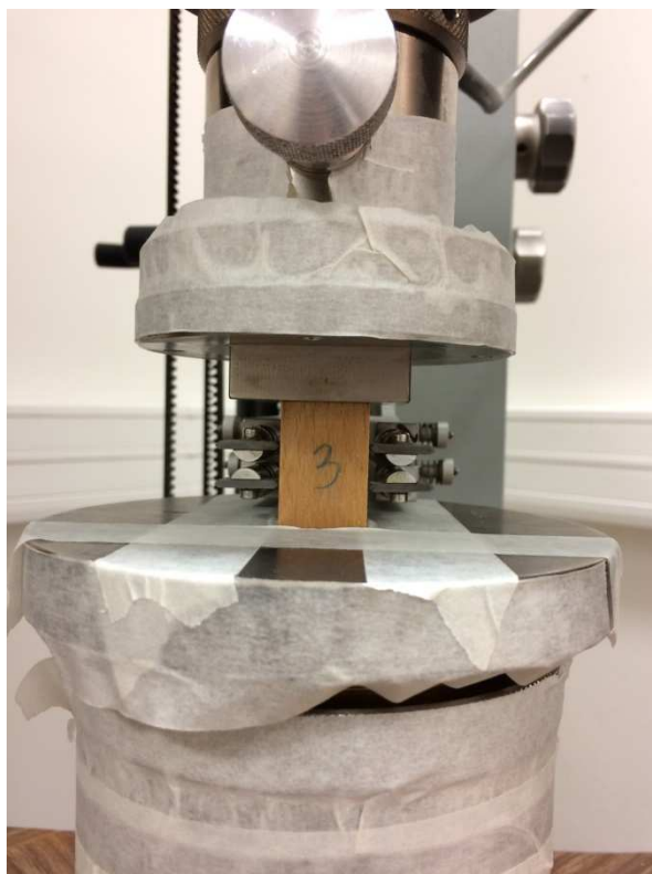
Obr. 14 Uložení tělíška naimpregnovaného smolnatou pryskyřicí ve zkušebním stroji Zwick
