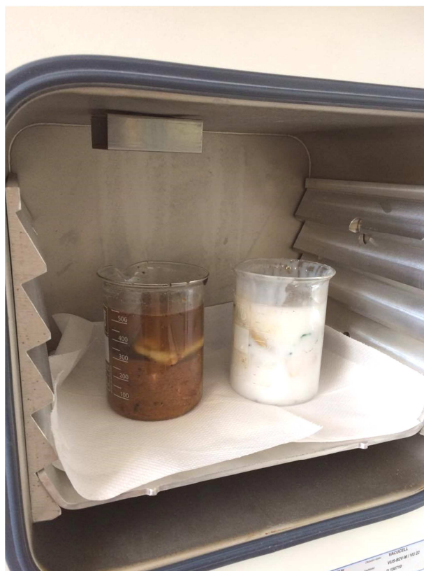
Obr. 7 Vzorky umístěné v prostoru sušárny na vakuovou impregnaci
