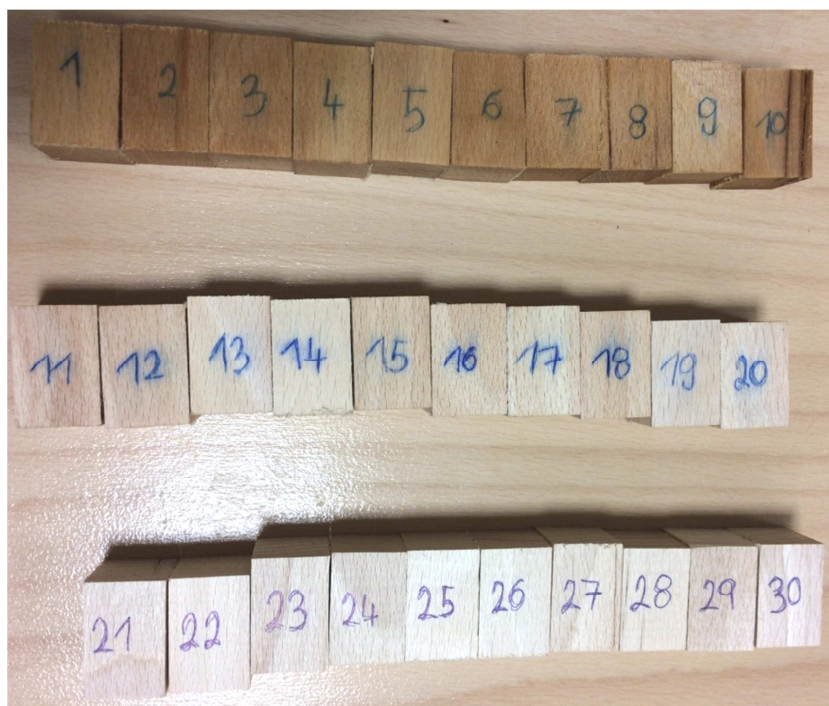
Obr. 11 Zkušební tělíska klimatizovaná při relativní vlhkosti 65% a teplotě 20°C po dobu 5 týdnů
