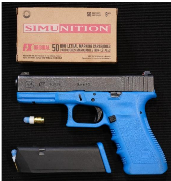
Obrázek č. 5 Výcviková pistole GLOCK 17 FX a cvičné střelivo FX, oboje od firmy Simunition 81
