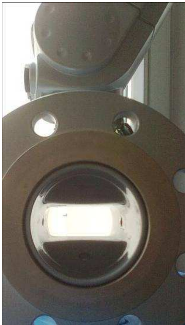
Obr. 4.6 Obdélníková měřící trubice k destabilizaci rychlostního pole
