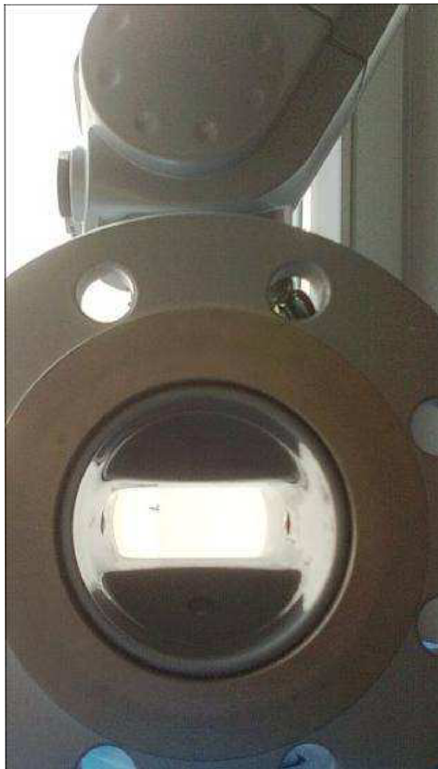
Obr. 4.6 Obdélníková měřící trubice k destabilizaci rychlostního pole
