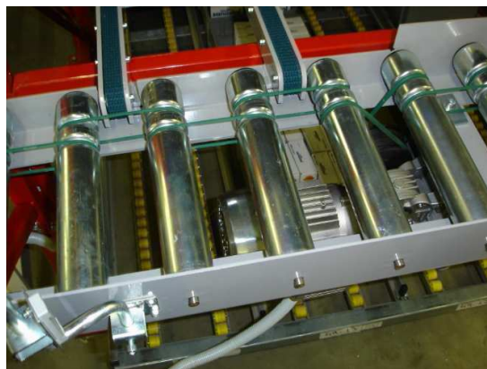
Obr. 22 Pohon oblouku kruhovými řemínky[12] Obr.23 Pohon přímého úseku tratě[12]
