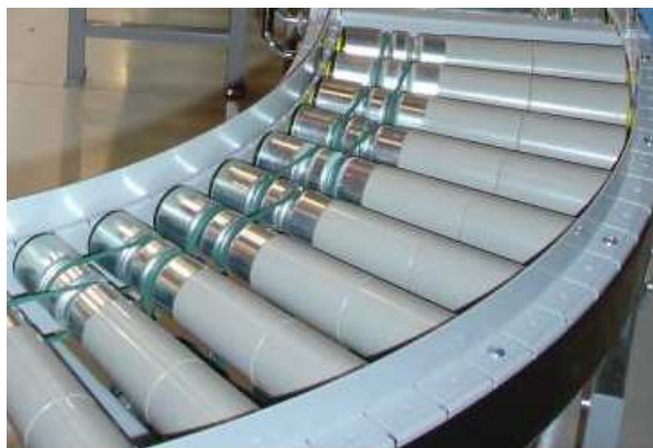
Obr. 22 Pohon oblouku kruhovými řemínky[12] Obr.23 Pohon přímého úseku tratě[12]
