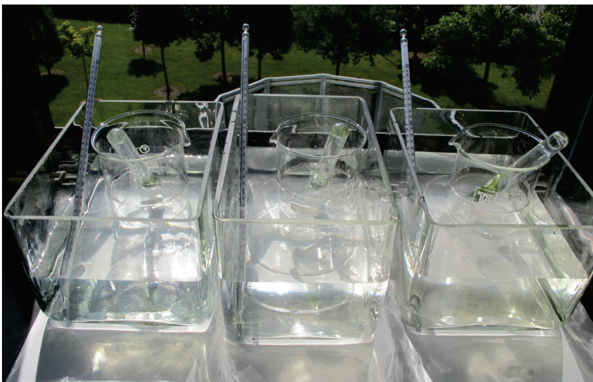
Obrázek 23: Uspořádání experimentu – tři soupravy s vodou o různé teplotě (35 °C, 20 °C a 10 °C).
