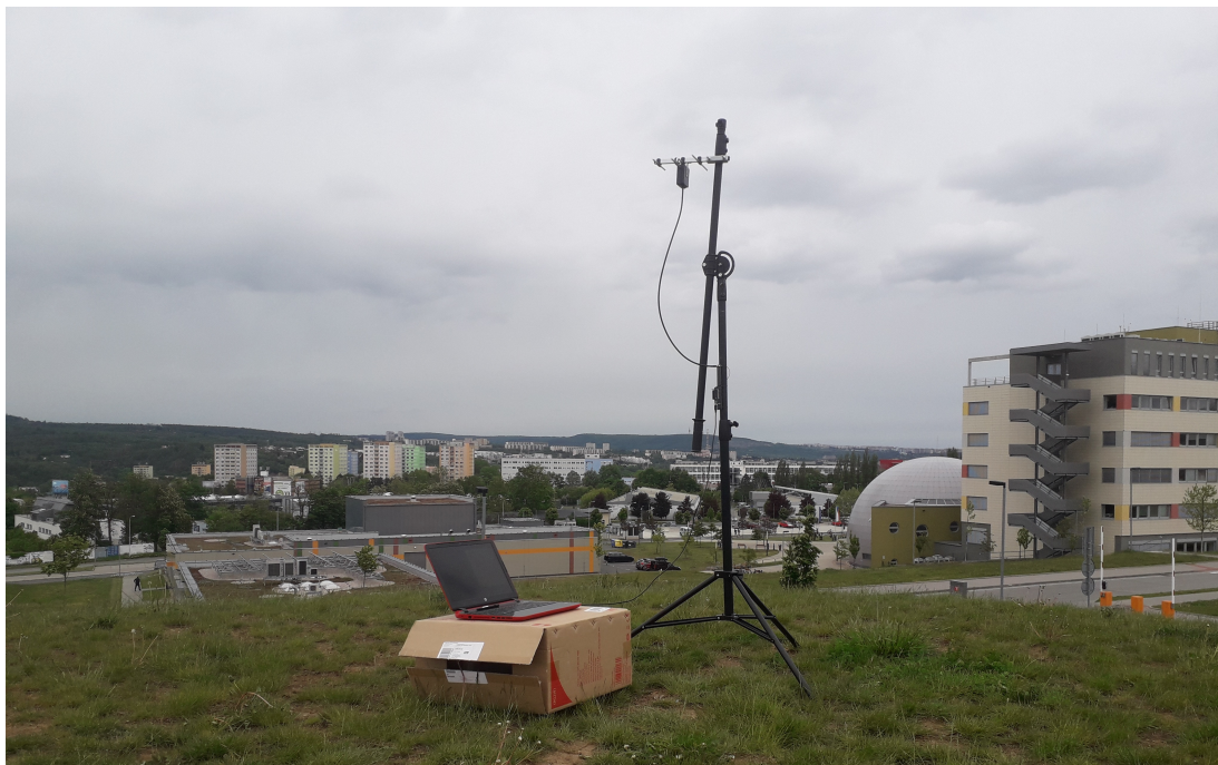
Obr. A.1: Stanoviško pro měření dosahu LoRa vysílače.
