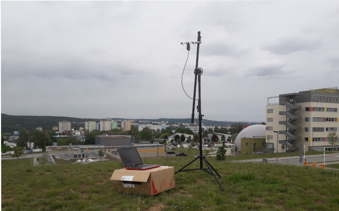
Obr. A.1: Stanoviště pro měření dosahu LoRa vysílače.
