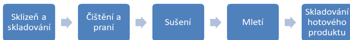
Obrázek č. 11 – Proudový diagram výroby mletého koření
