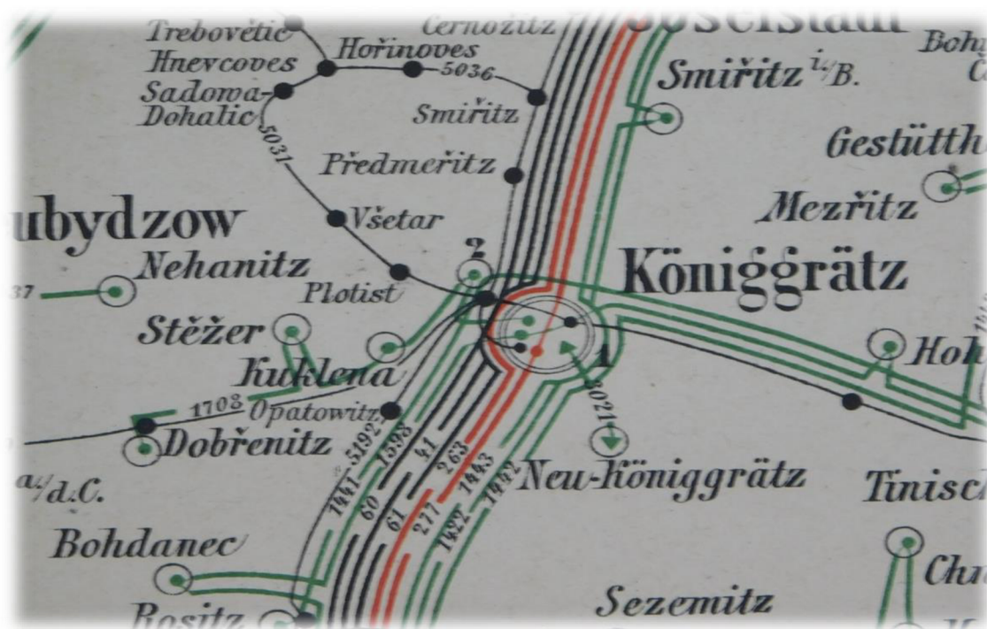
Obr. 3 - telegrafní síť, stav k 1. 7.1901; červená barva - hlavní říšská linie, zelená barva - vedlejší linie, černá barva - železniční trať
