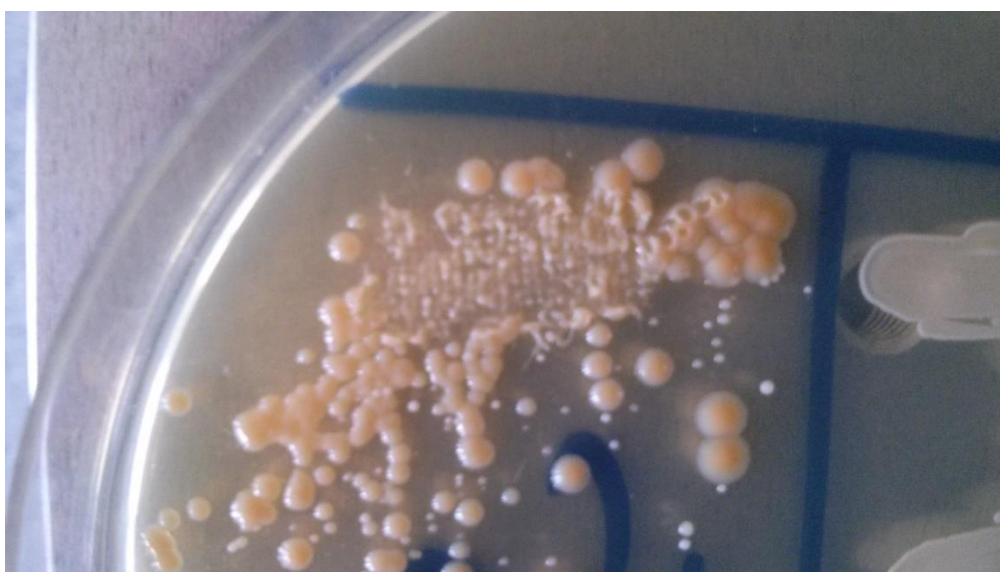
Obr. 16: Fotka vypěstovaných kolonií Staphylococcus aureus . 250 LIBS měření proběhlo na oblasti 16,25 x 6,5 mm.
