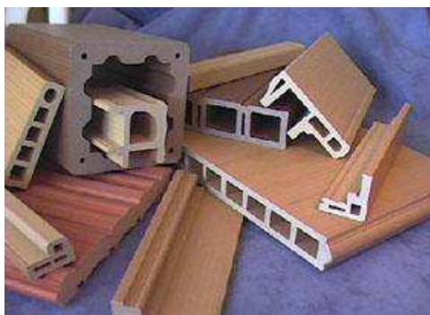
Obr. č. 6: WPC – Wood-Plastic Composites (Mojeterasa)
