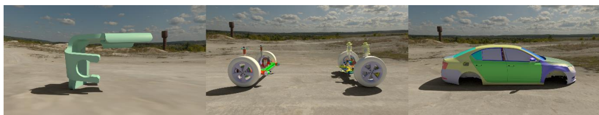
Obrázek 17: Ukázka modelů: zleva brzdový spínač držáku, náprava a karoserie
