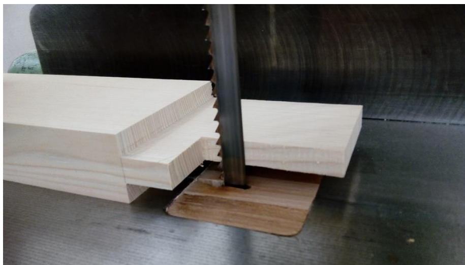
Obrázek 47 - Podélné řezání čepů na pásové pile
