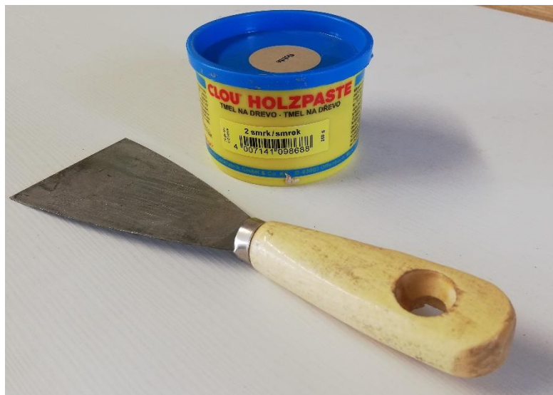
Obrázek 36 - Spárovací tmel se stěrkou
