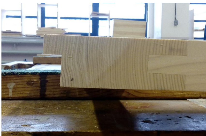
Obrázek 51 - Polodrážka na svislém bočním vlysu
