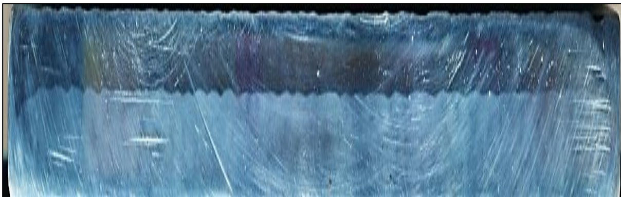
b) svar číslo 2 ( P=2 \text{ kW} , v=20 \text{ mm}\cdot\text{s}^{-1} )
