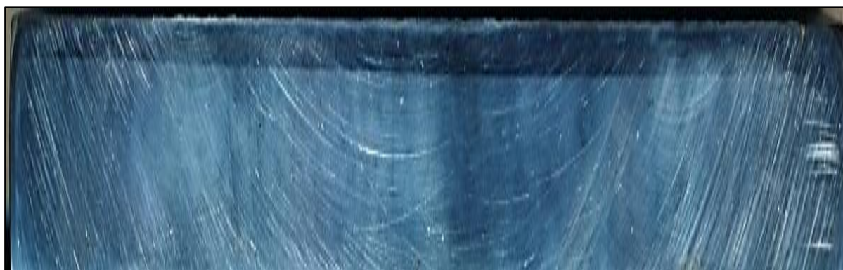
b) svar číslo 6 ( P=1\text{ kW} , v=30\text{ mm}\cdot\text{s}^{-1} )
