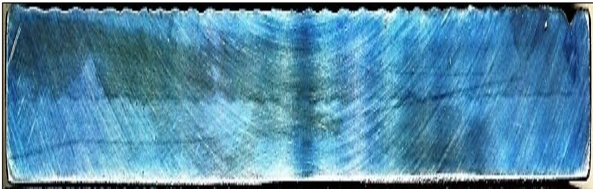
a) svar číslo 1 ( P=2 \text{ kW} , v=10 \text{ mm}\cdot\text{s}^{-1} )
