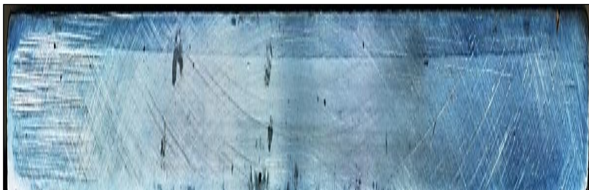
a) svar číslo 5 ( P=1\text{ kW} , v=20\text{ mm}\cdot\text{s}^{-1} )
