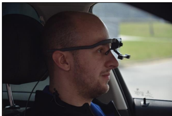
Obr. 68: Řidič s nasazeným zařízením pro sledování směru pohledu Dikabliss [zdroj vlastní]
