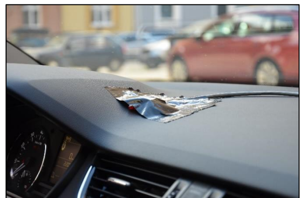
Obr. 60: LED dioda indikující aktivaci brzdové soustavy [zdroj vlastní]
