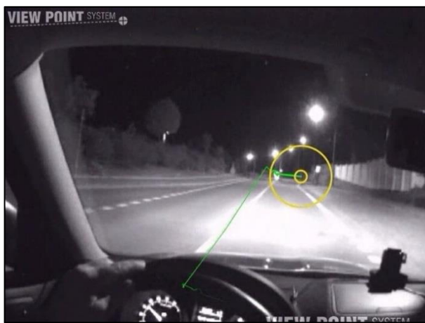
Obr. 38: Figurant v oblasti ostrého vidění (8,52 s a 65,9 m před přechodem); oko řidiče po změně směru pohledu fixuje figuranta (jízda J12 přechod A_P2)
