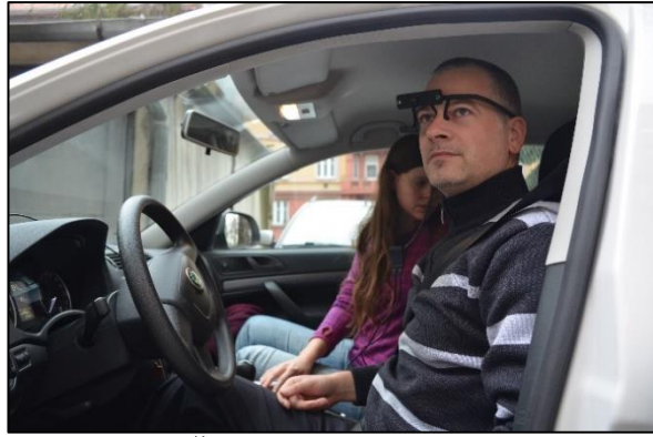
Obr. 49: Řidič s nasazeným zařízením pro sledování směru pohledu Pupil Labs [zdroj vlastní]
