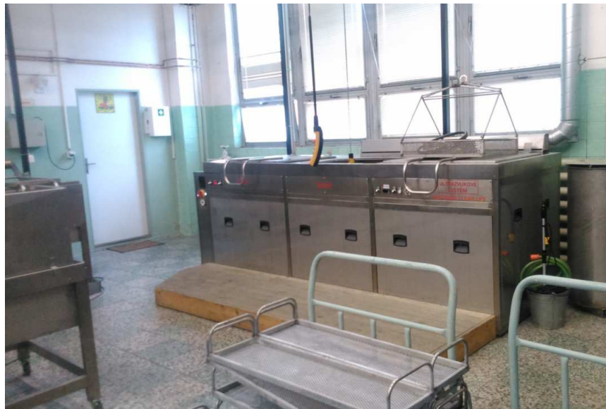
Obrázek 5.2 – Pracoviště kapilární defektoskopie LOM (Letecké opravny Malešice)
