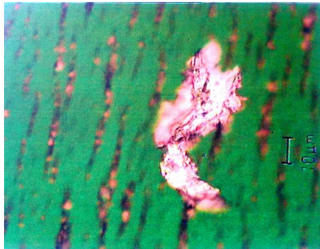
Obrázek 6.4 - Ferrogram - zachycení nemagnetické částice [6]
