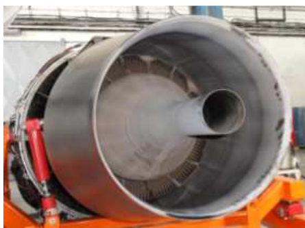
Obrázek 1.2 - Dvouproudový motor během technické údržby (zadní část) [19]
