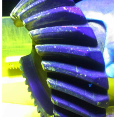
Obrázek 5.7 - Viditelné trhlinky po magnetické defektoskopii
