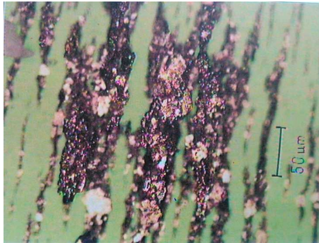
Obrázek 6.3 - Ferrogram - zachycení částic Fe [6]
