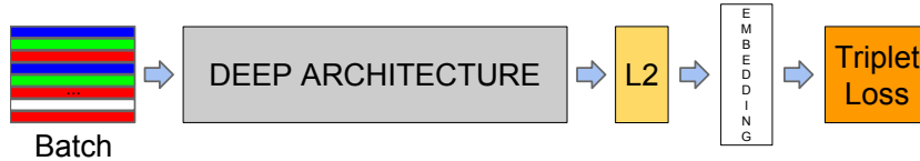
Obrázek 2.9: Architektura modelu FaceNet. Tato síť se skládá z dávkové vstupní vrstvy, hluboké konvoluční neuronové sítě, za kterou následuje L_2 normalizace, jejíž výstupem je face embedding . Během trénování sítě je tato fáze následována triplet loss funkcí. Převzato z [31].
