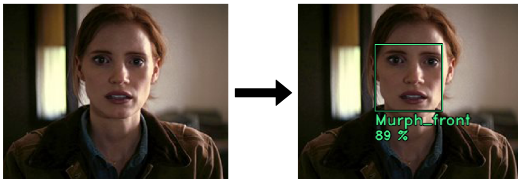
Obrázek 5.4: Ukázka vstupu a výstupu identifikace obličeje. Pro trénování modelu byly použity 3 snímky. Hodnota prahu faceDistanceThreshold byla 0,58.
