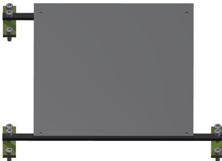
Obr. č. 26: Náklonný stoleček. Stoleček je podepřen dvěma ocelovými hranolky a stojí na třech opěrných bodech vytvořenými šrouby s tlačnou kuličkou. Šrouby se pohybují ve vybrání svírající úhel 17^\circ .
