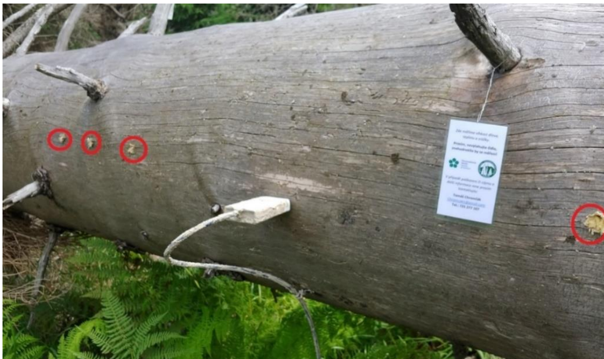
Obr. 8.: Ukázka nainstalovaného čidla. V řadě zvýrazněny odběry pomocí přírůstového vrtáku (vývrtové otvory jsou zaslepeny štěpařským voskem).
