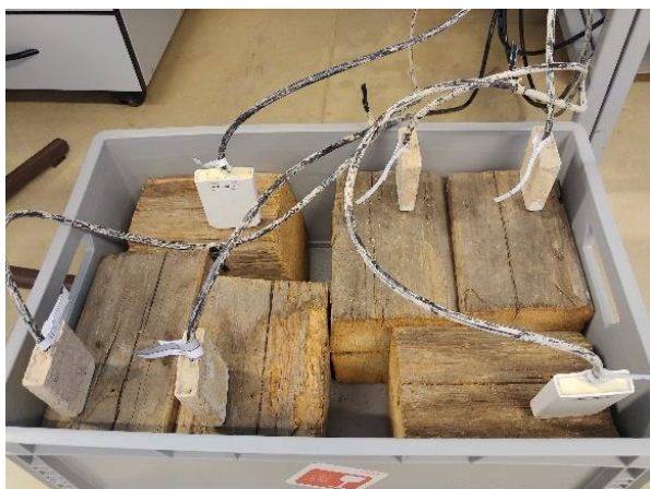
Obr. 9: Trámy v nejsušším stavu zavedenými čidly.
