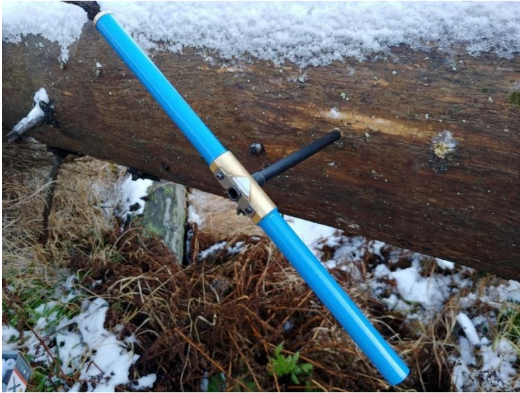
Obr. 3: Odběr pomocí přírůstového vrtáku.
