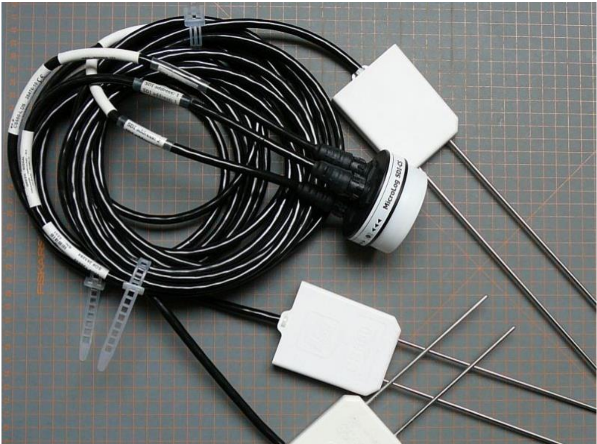
Obr. 5: Sada pro měření kontinuální vlhkosti. Čidla CS65X napojena na datalogger MicroLog SDI CS.
