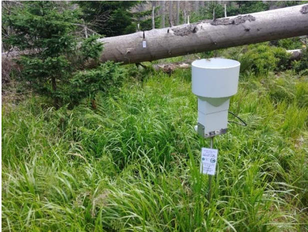
Obr. 6: Ukázka srážkoměru Pronamic na lokalitě Alpa.
