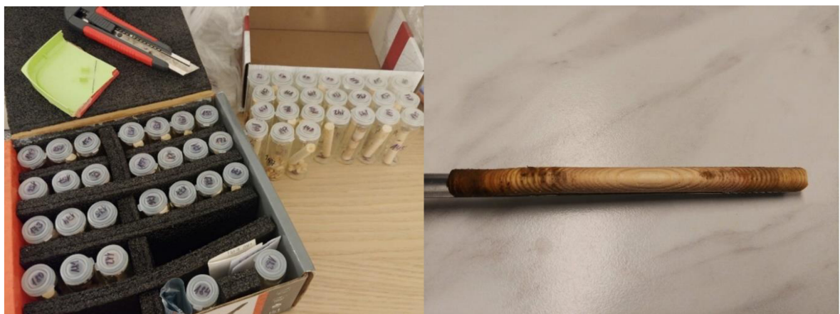
Obr. 4: Ukázka odběrné sady: sada označených vialek, zařezávací nůž a odměrná destička. Extraktor se vzorkem dřeva.
