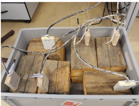
Obr. 9: Trámy v nejsušším stavu zavedenými čidly.
