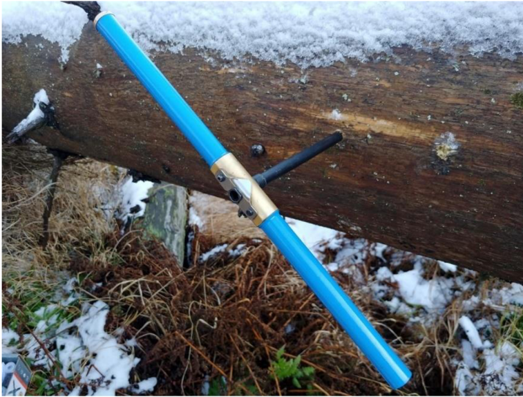
Obr. 3: Odběr pomocí přírůstového vrtáku.
