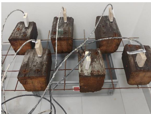
Obr. 9: Trámy v nejsušším stavu zavedenými čidly.
