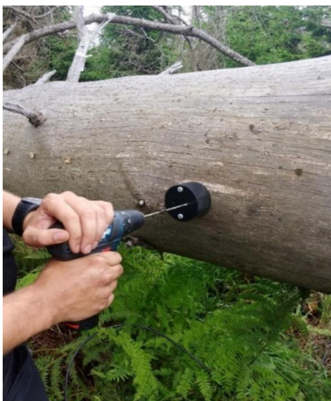
Obr. 7: Ukázka instalace čidla do kmene – plastový unašeč navádějící vrták.
