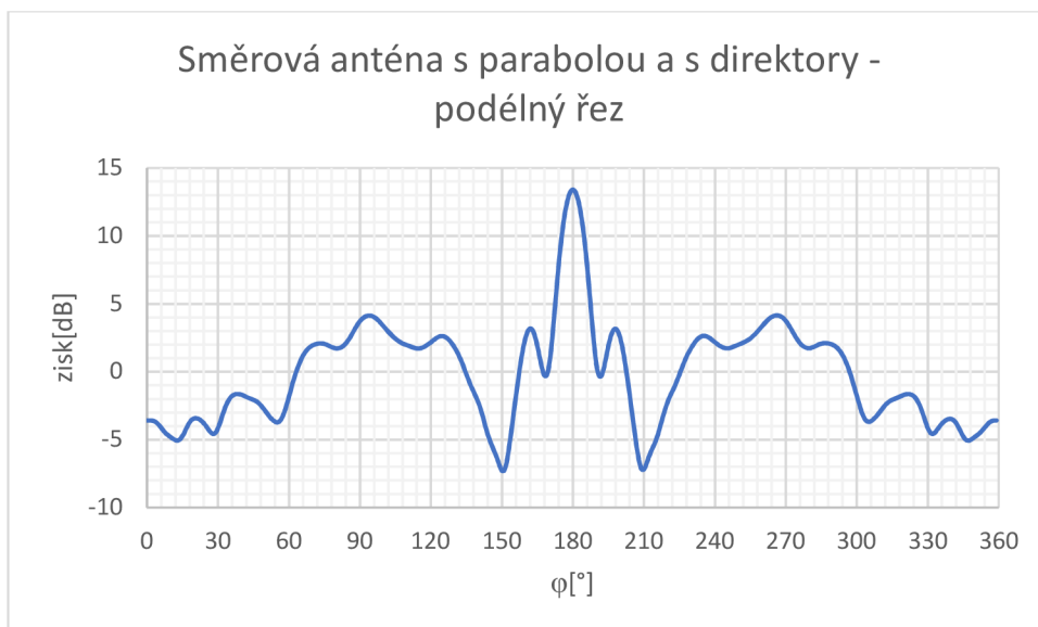
Obrázek 4.15: Vyzařovací charakteristika směrové monopólové antény s parabolou a s direktory v podélném řezu
